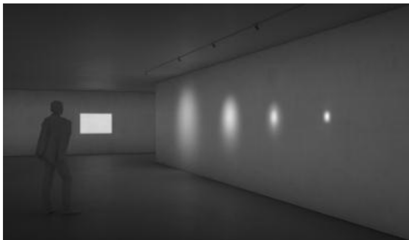
Image 3: Visualisation effet de cadre SUPERSYSTEM réflecteur de 40, 24, 16 et 8 degrés.
