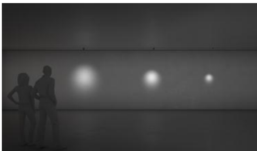
Image 4: Visualisation Zumtobel SUPERSYSTEM taille de projecteur 65 mm, 45 mm, 25 mm frontal.
